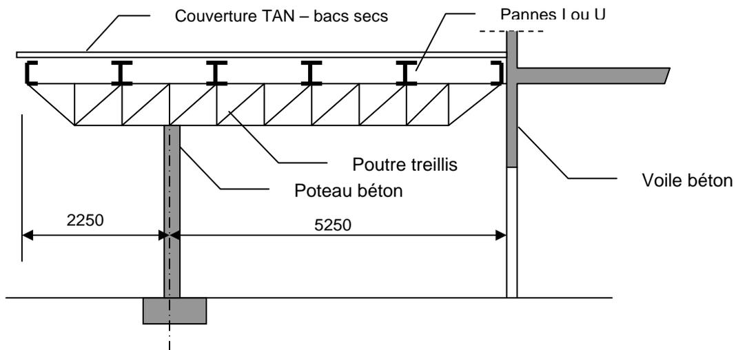
Les 4 poutres treillis sont espacées de 5 mètres de façon à réaliser un auvent de 15 mètres de largeur. Les pannes isostatiques sont espacées de 1.5 mètres et reposent à leurs extrémités sur les poutres treillis. (La pente de la structure n'est pas représentée et n'est pas prise en considération).
