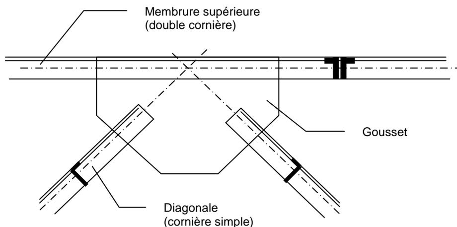
Le schéma mécanique de la poutre treillis (hauteur de 750 mm et trame de 10 x 750 mm) :
