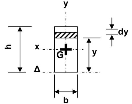
Le moment statique, par rapport à un axe quelconque d'une section de surface  $A$ , est le produit de la surface  $A$  par la distance de son centre de gravité à cet axe quelconque (qui ne passe pas par le centre de gravité de la section).
